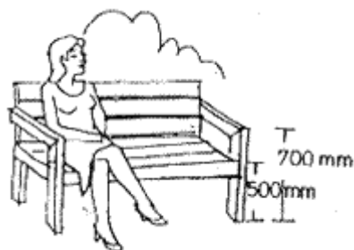
Фиг. 27. Основни размери на пейка за почивка. височина на седалката - 500 мм. височина на страничната облегалка - 700 мм
